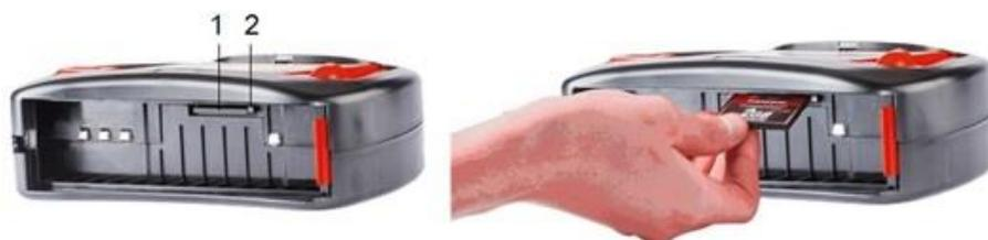
**Fig. 16 Inserción/sustitución de la SaveCard**
